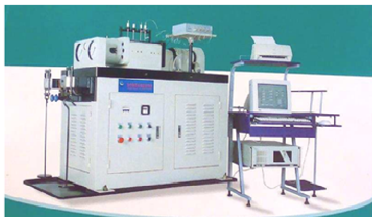
图 1 ABLT- 1A 型滚动轴承疲劳寿命及可靠性强化试验机
